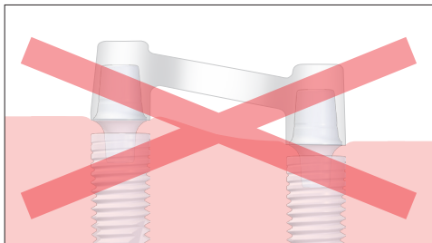
Diagramme schématique : pas de disposition inclinée de la barre de liaison
