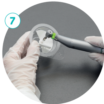
7 Posez l'adaptateur contre-angle ou à cliquet en exerçant une pression
